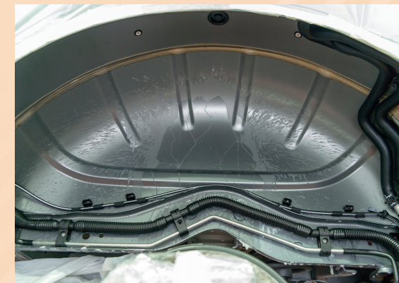
Beispiel: Radkasten ohne Abdeckung unbehandelt
