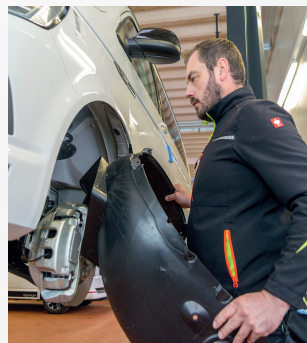
Abbau der Abdeckungen
