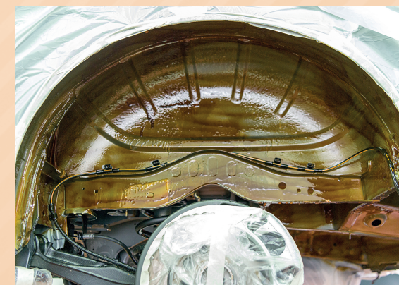
Beispiel: Radkasten ohne Abdeckung mit DINITROL-Systemschutz behandelt
